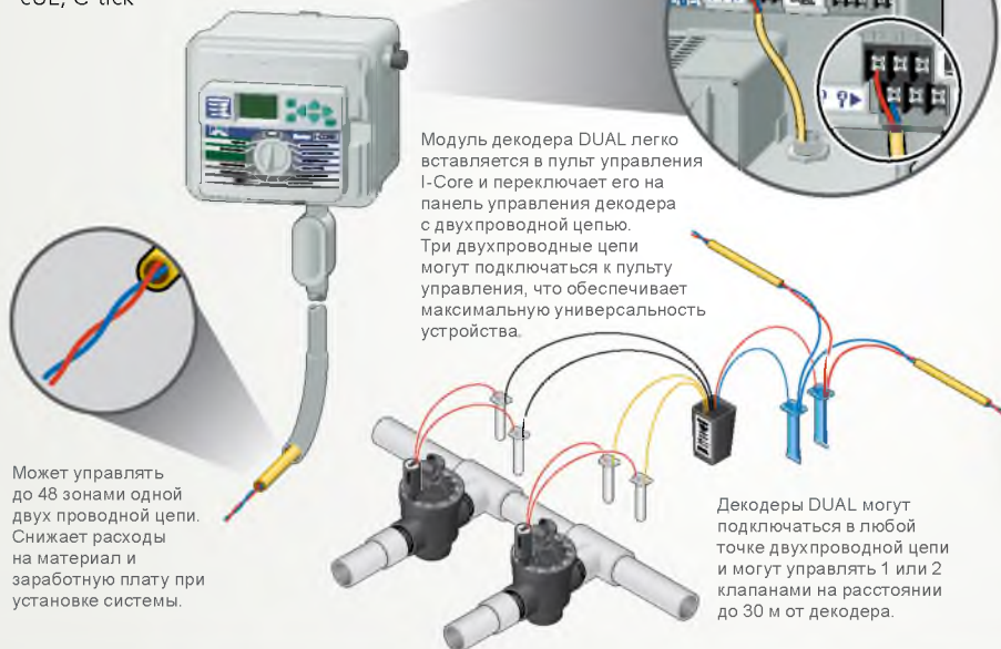
Модуль декодера DUAL: В 3.5 см x Ш 11.1 см x Г 10.1 см
